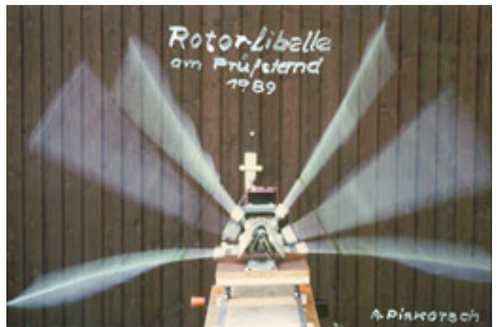
Bild 1.20 Rotationsschlagflügel von Adolf Piskorsch, noch in der Deutschen Versuchsanstalt für Luftfahrt in Berlin (DVL) als „iron bird“ gebaut und nach 45 Jahre mit Membranflügeln auf dem Prüfstand.
