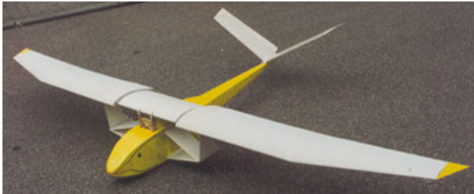
Bild 2.18 Nachbau des Schlagflügelmodells von DeLaurier, mit Elektroantrieb, von Horst Händler, 1992.
