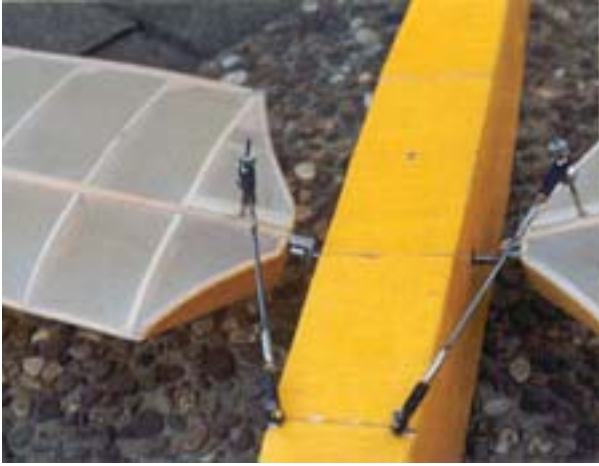
Bild 1.21 Rotationsflügelmodell von Horst Händler, 1989. Die Profilflügel stecken jeweils auf einem abgewinkelten Ende der angetriebenen Welle. Durch Hebel wird der Einstellwinkel immer an die jeweilige "Schlagrichtung" angepasst.
