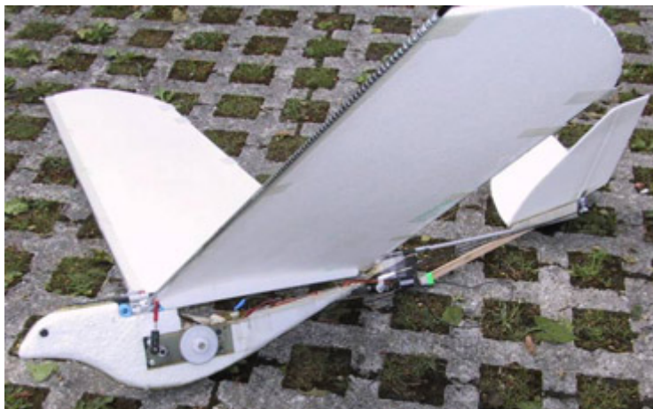
Bild 2.21 Ornithopter mit relativ schwach gewölbten Schalenflügeln hergestellt aus 3 mm dickem Schaumstoff (DEPRON) von Karel Pustka, München 2003.
