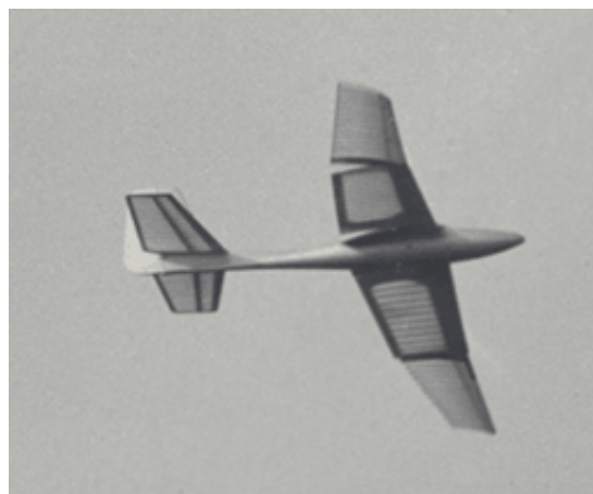
Bild 2.9 Schlagflügelmodell EV4 mit stufiger Verwindung, 1979.
