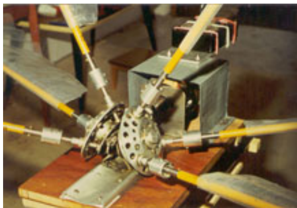
Bild 1.20 Rotationsschlagflügel von Adolf Piskorsch, noch in der Deutschen Versuchsanstalt für Luftfahrt in Berlin (DVL) als „iron bird“ gebaut und nach 45 Jahre mit Membranflügeln auf dem Prüfstand.
