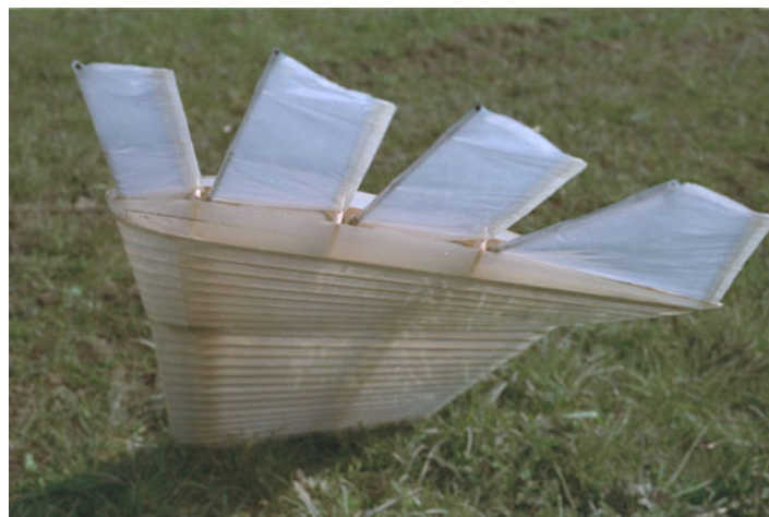
Bild 2.3 Flügel des Schlagflügelmodells EV7b , ein Beispiel für eine aufgefächerte Flügelspitze mit einfachen, aeroelastischen Membranfedern.
