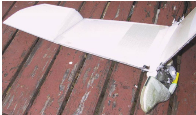
Bild 2.11 Styropor-Schlagflügel mit „Verwindung“ von Karel Pustka, München 2004.
