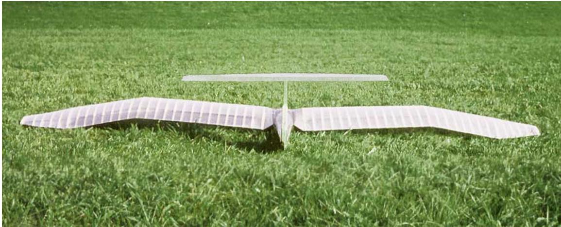
Bild 2.22 Ornithoptermodell EV6 mit seinen Gelenkschlagflügeln.
